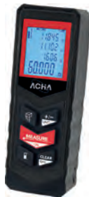
MEDIDOR DE DISTANCIA LÁSER ECO-MINI Unidades en: mm / pulgadas / pies. Resolución: 0.001 m (1 mm). Precisión: ±3 mm. Medida de área y volumen. Función medición directa y continua. Función añadir / restar mediciones. Cálculo por el teorema de Pitágoras. 2 puntos de referencia de medición. Tipo de láser: 635 nm. Clase II. Correa incluida. IP54. 2 Pilas AAA incluidas. 27935008 40 m. 67'56 + IVA = 81'75 27935007 60 m. 77'64 + IVA = 93'95
